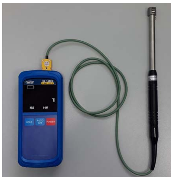
Рисунок 1 - Общий вид термометров цифровых HD-1450K в комплекте со сменным измерительным зондом А-241К-01-1-ТС1-АНР
