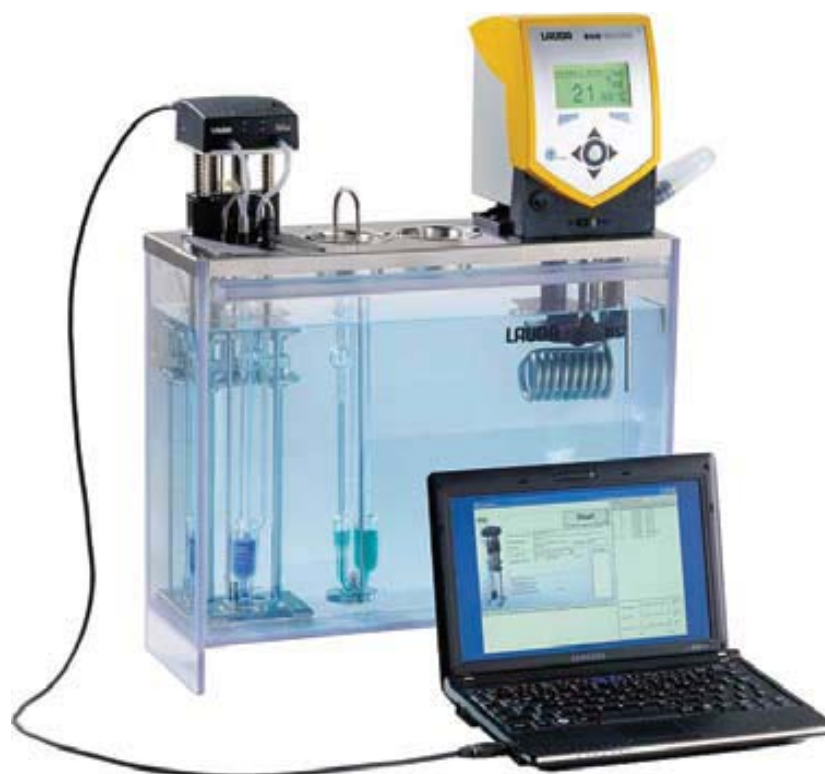
Рисунок 1 - Общий вид системы измерения вязкости автоматической iVisc
