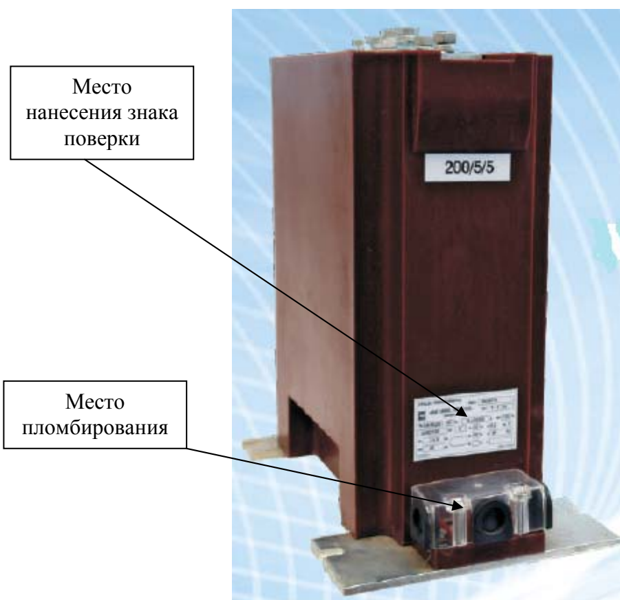
Рисунок 3 - Общий вид трансформаторов серии AN 36/250 с местами пломбировки от несанкционированного доступа и нанесения знака поверки
