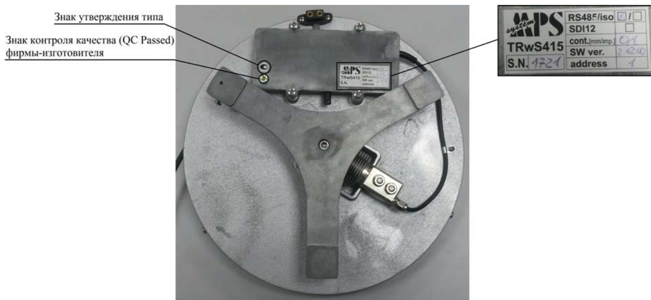
Рисунок 2 - Внешний вид станины и крышки корпуса электронного оборудования
