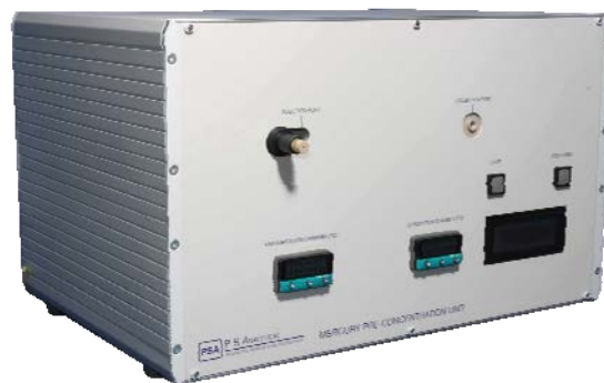
Рисунок 4 - Общий вид приставки для жидких углеводородов PSA 10.515
