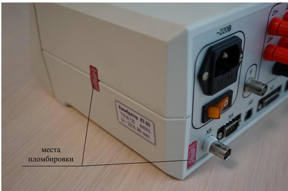
Рисунок 2 – Схема пломбировки от несанкционированного доступа
