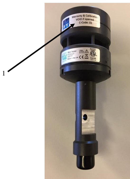
Рисунок 2 — Схема пломбирования датчика: 1 – пломбы на корпусе датчика в виде этикетки
