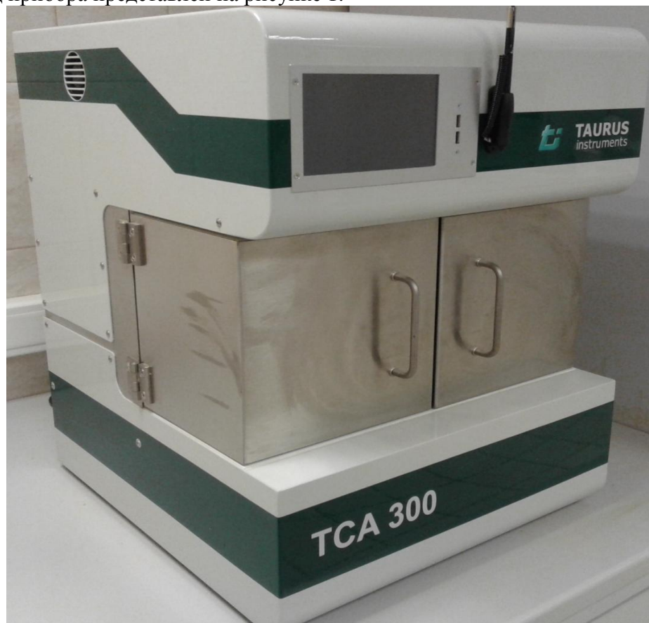
Рисунок 1 – Общий вид прибора для измерения теплопроводности Taurus TCA 300-DTX
