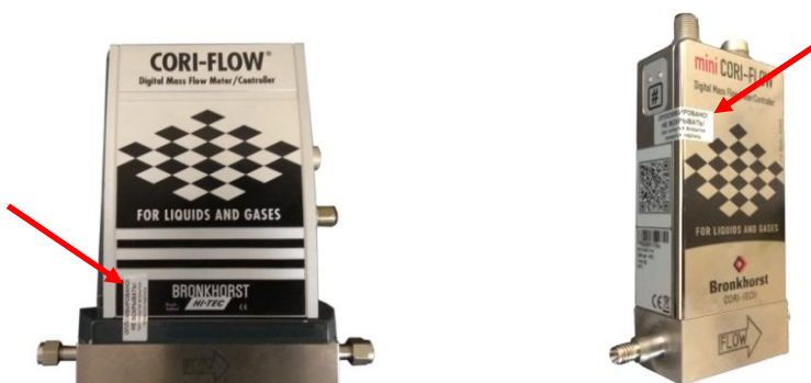
Рисунок 3 – Схема пломбировки от несанкционированного доступа блока измерений систем измерений и регулирования расхода CORI-FLOW и mini CORI-FLOW
