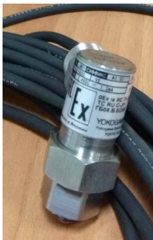
Рисунок 3 – Общий вид пьезоэлектрического акселерометра LN01
