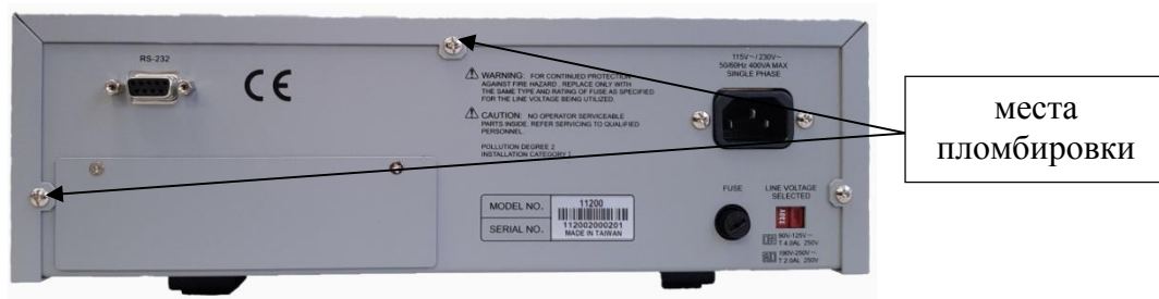
Рисунок 2 – Схема пломбировки от несанкционированного доступа
