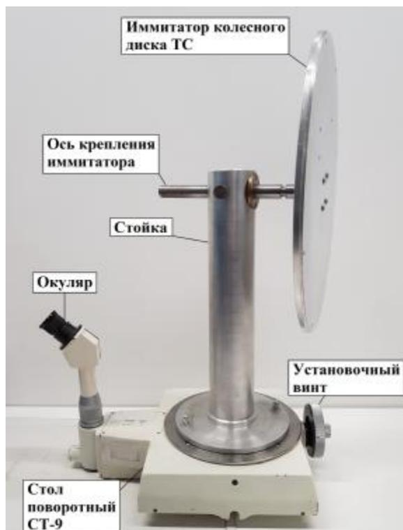
Рисунок 1 – Общий вид установок угломерных на основе столов поворотных СТ-9
