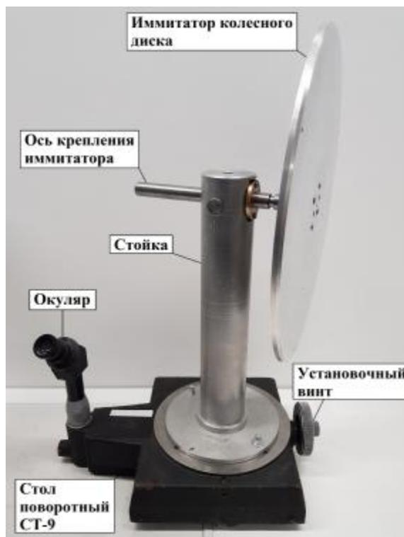
Рисунок 2 – Общий вид установок угломерных на основе столов поворотных СТ-9
