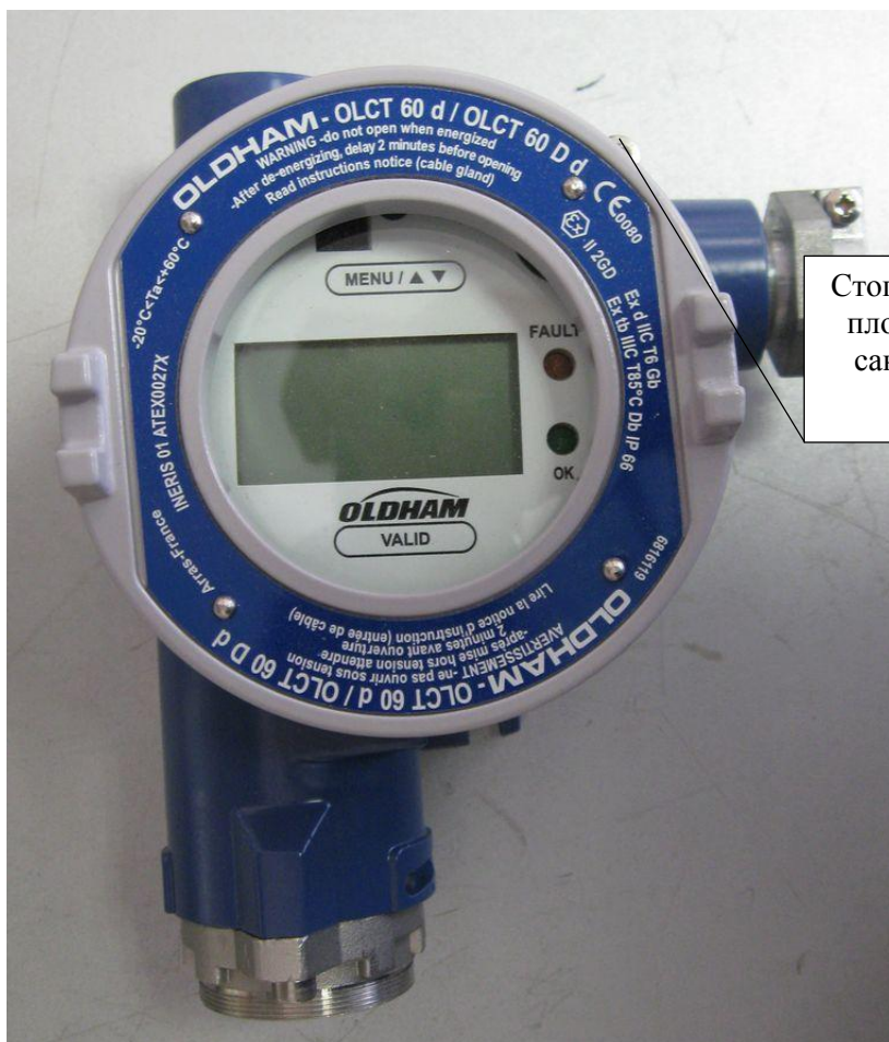
Рисунок 2 – Схема пломбирования датчиков (на примере OLCT 60)
