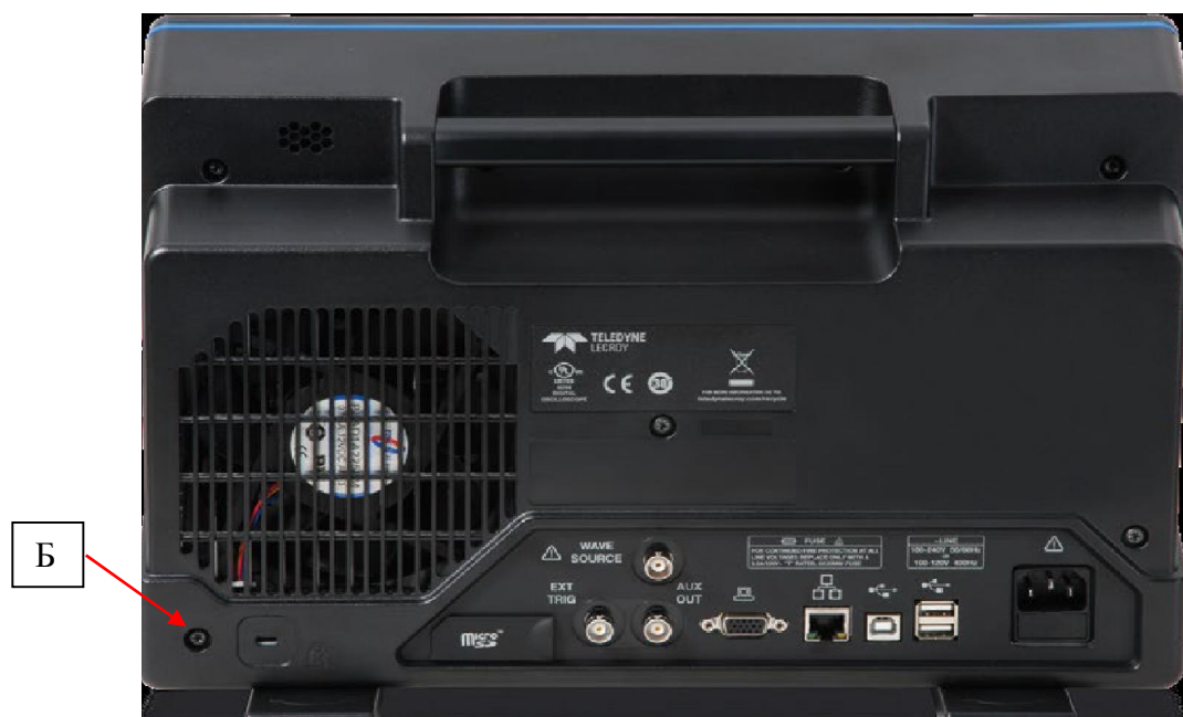
Рисунок 2 – Вид задней панели осциллографов и место пломбировки от несанкционированного доступа (Б)
