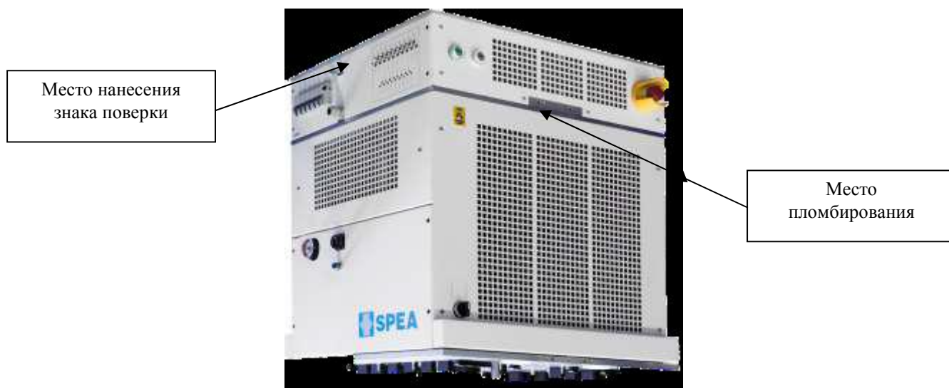
Рисунок 1 – Общий вид тестеров SPEA DOT400, места пломбирования и нанесения знака поверки
