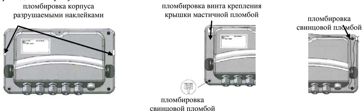
Рисунок 3 — Схема пломбировки приборов весоизмерительных *i* 30, *i* 35
