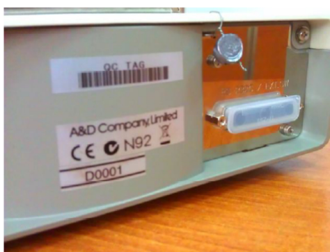
Рисунок 2 – Схема пломбировки весов от несанкционированного доступа
