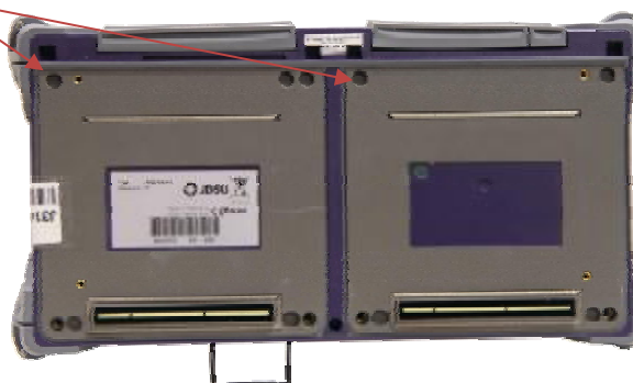
Рисунок 2 - Задняя панель MTS-4000 со схемой пломбировки
