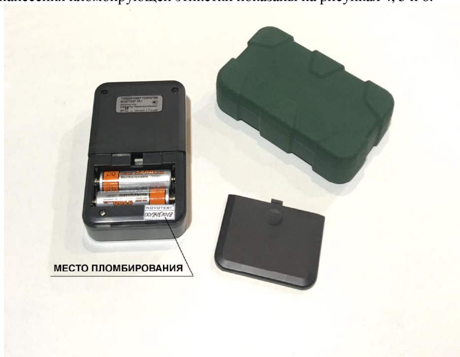
Рисунок 4 – Место пломбирования корпуса толщиномеров покрытий NOVOTEST ТП-1
