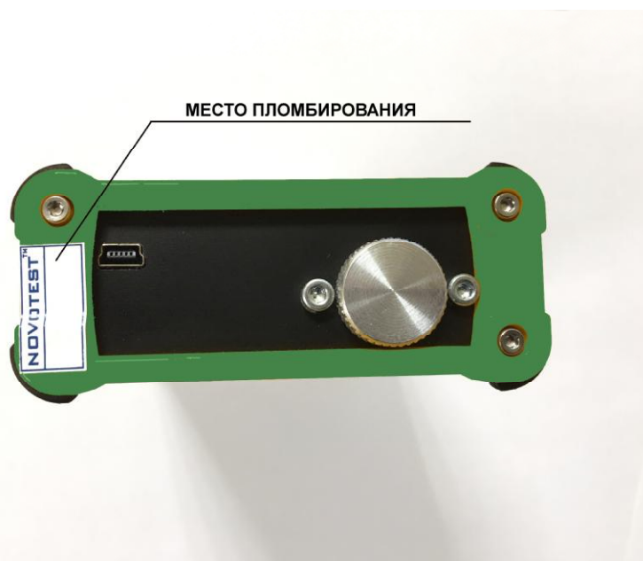
Рисунок 6 – Место пломбирования корпуса толщиномеров покрытий NOVOTEST ТП-1-СТ
