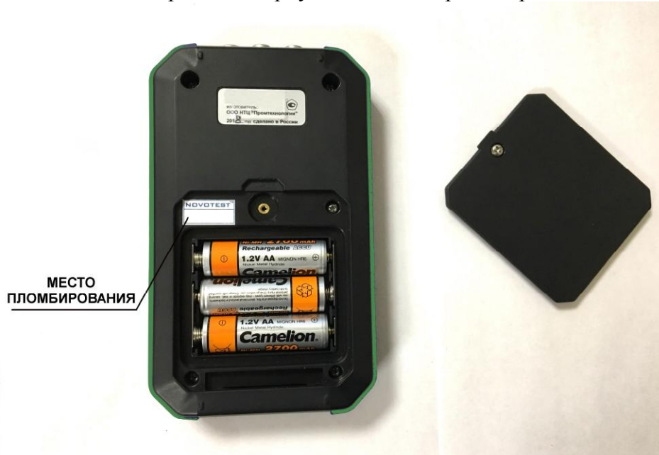
Рисунок 5 – Место пломбирования корпуса толщиномеров покрытий NOVOTEST ТП-1-IP
