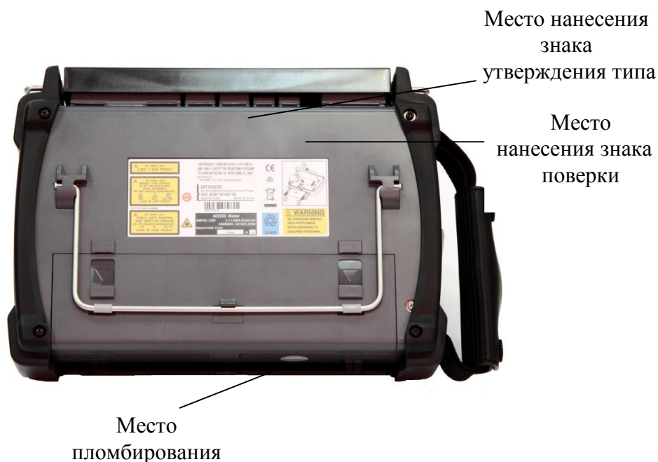
Рисунок 2 – Задняя панель рефлектометров со схемой пломбирования от несанкционированного доступа и местом нанесения знака утверждения типа и поверки
