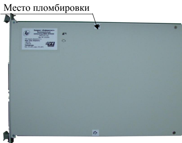
Рисунок 2 – Схема пломбировки от несанкционированного доступа
