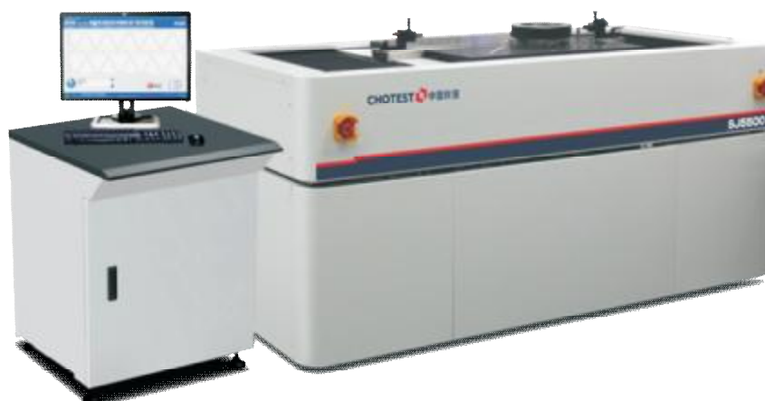
Рисунок 3 – Общий вид приборов для измерений параметров гладких и резьбовых калибров серии SJ5500
