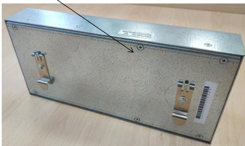
б) место пломбировки от несанкционированного доступа модулей модификации БЭ2005М-КП
