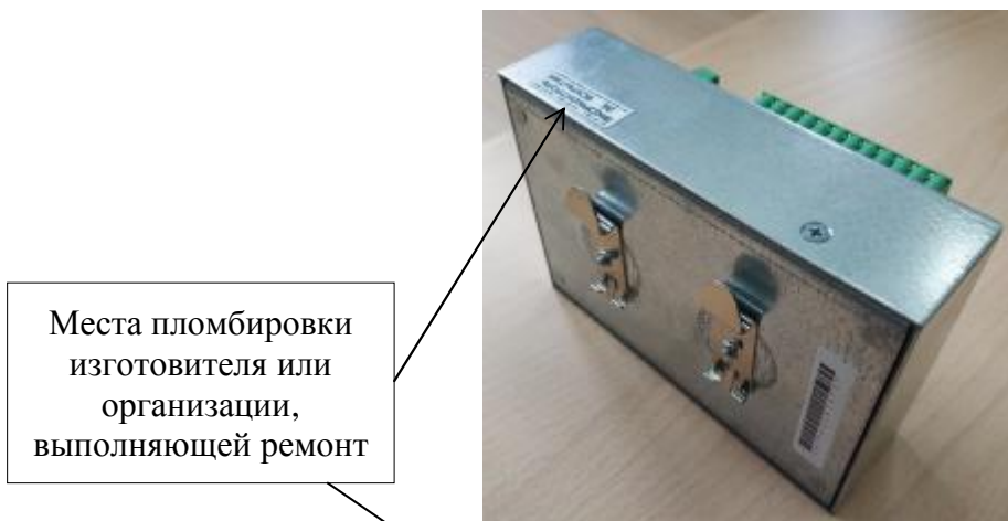
а) место пломбировки от несанкционированного доступа модулей модификации БЭ2005М-ИП
