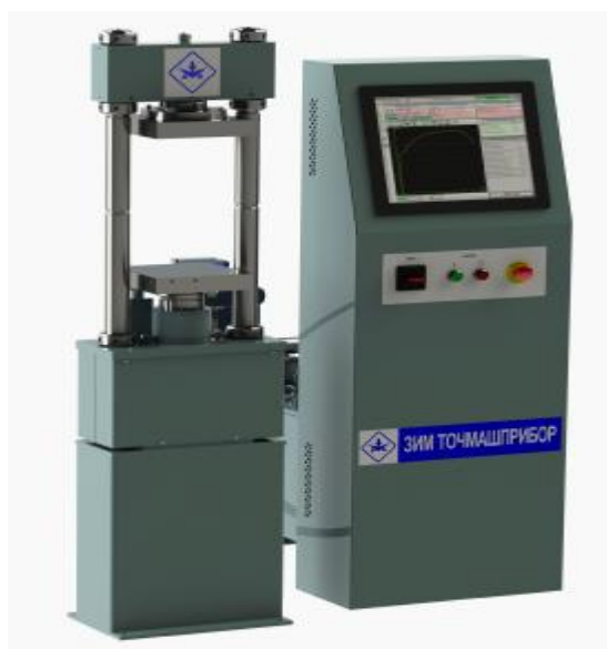
Рисунок 1 – Общий вид стенда испытательного сжатия СИС–50 А–1.
