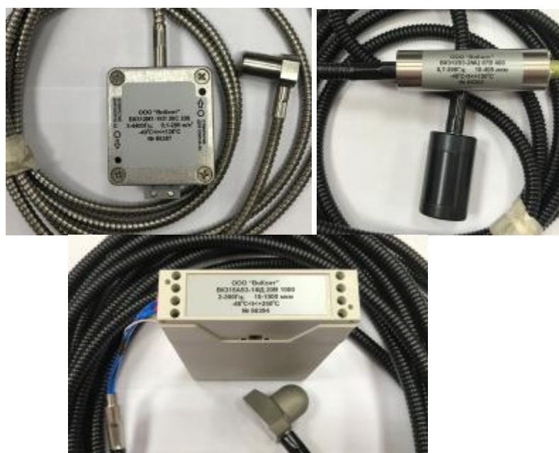
Рисунок 3 - Общий вид вибропреобразователей серии ВК-310 с выносным предусилителем
