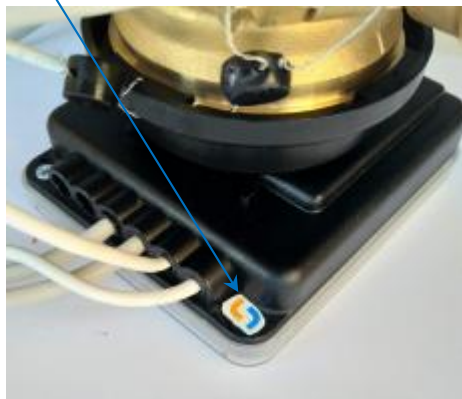
б) схема пломбировки вычислителя модификаций «SANEXT» Mono RUX и «SANEXT» Mono RMX
