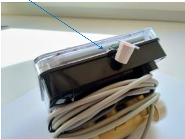
а) схема пломбировки вычислителя модификаций «SANEXT» Mono IoT
