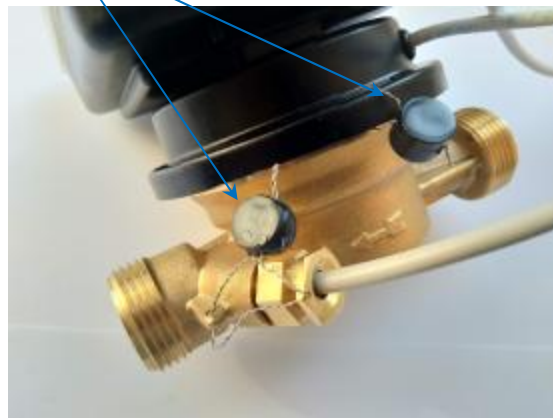
г) схема пломбировки датчика объёмного расхода модификаций «SANEXT» Mono RMX
