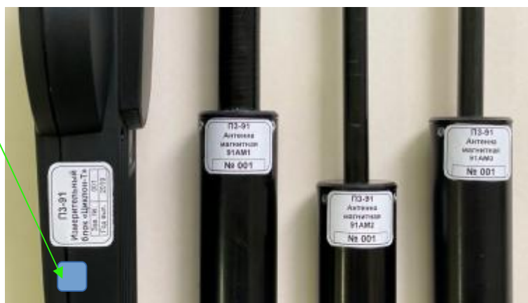
Рисунок 2 - Маркировка и схема пломбировки от несанкционированного доступа
