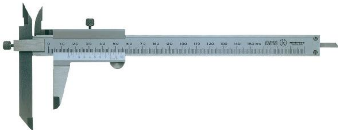
Рисунок 2 - Общий вид штангенциркулей серии 536 модификации нониусный с регулируемой губкой
