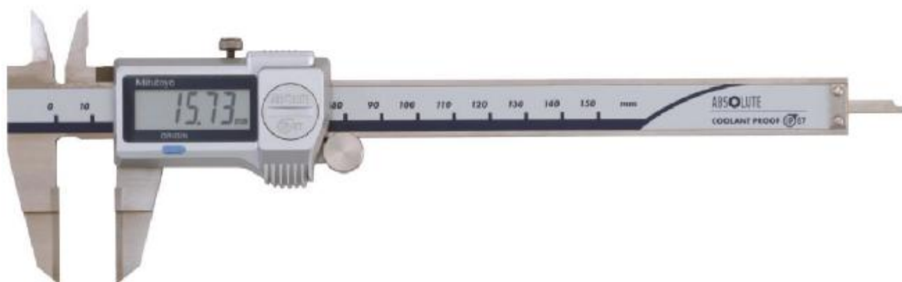
Рисунок 22 - Общий вид штангенциркулей серии 573 модификации ABSOLUTE Digimatic с тонкими губками
