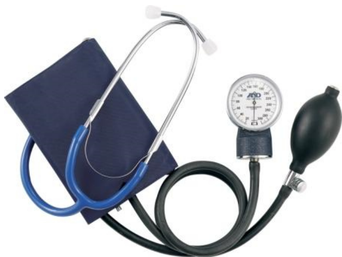
Рисунок 1 – Общий вид приборов для измерения артериального давления, модели: UA-100, UA-100 SL, UA-100 Эконом
