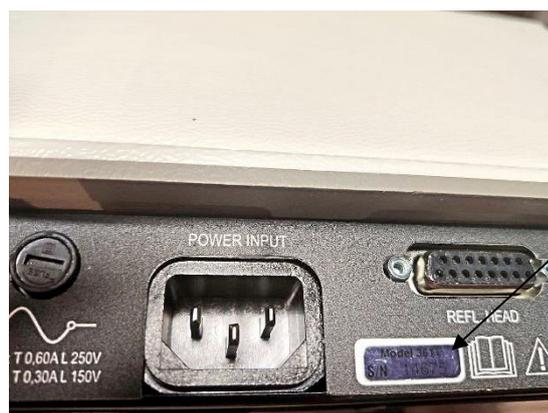
Рисунок 2 – Обозначение места нанесения маркировки и заводского номера
