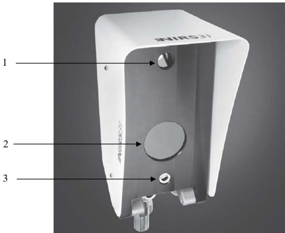
Рисунок 1 – Общий вид измерителей NIRS31-UMB 1 – приемник, 2 – излучатель, 3 - пирометр
