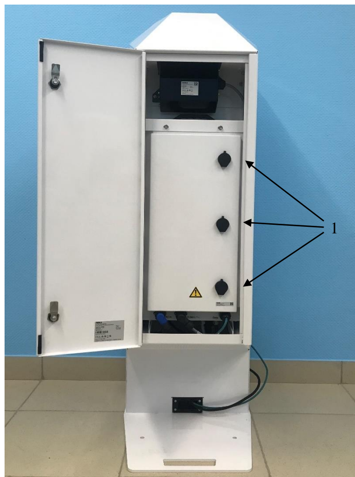
Рисунок 2 – Схема расположения замков на измерителях CL61
