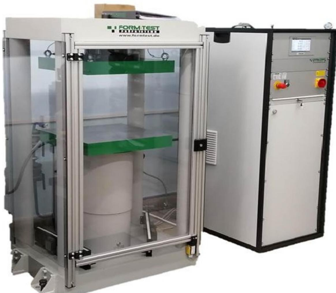
Рисунок 2 – Общий вид машины испытательной FORM+TEST ALPHA 1-500 S
