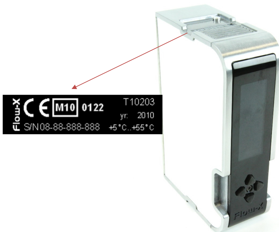
Рисунок 7 - Место нанесения заводского (серийного) номера на вычислителе Flow-X. Схемы и места пломбирования вычислителей Flow-X представлены на рисунке 8
