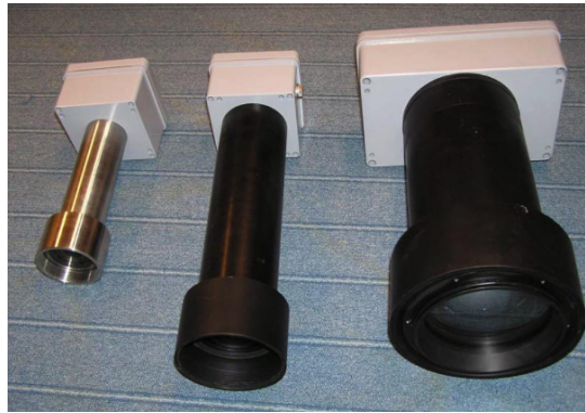
Рисунок 10 – блок приемника анализатора пыли LaserDust (исполнения слева направо: MP, LP, XLP)
