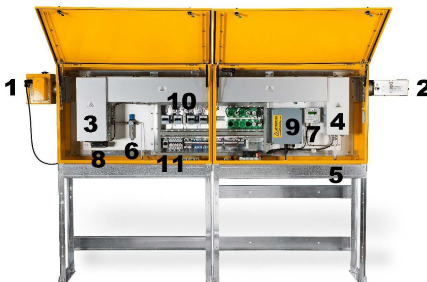
Рисунок 6 - Специализированный шкаф для измерений методом горячей влажной экстракции.
