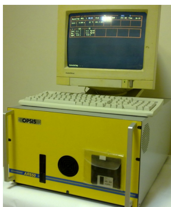
Рисунок 3 - Центральный блок газоанализаторов AR600, AR650
