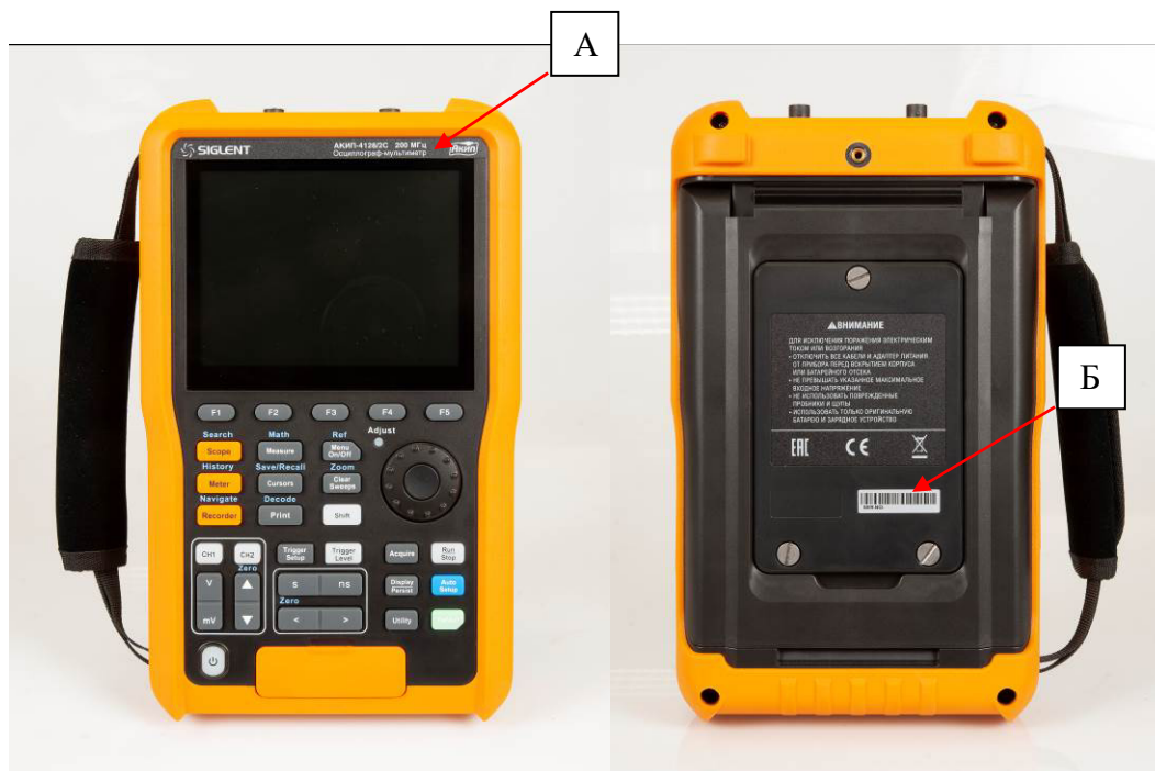
Рисунок 1 – Общий вид осциллографов-мультиметров, место нанесения знака утверждения типа (А) и серийного номера (Б)
