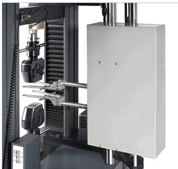
Рисунок 1 – Общий вид измерителей перемещений (деформаций) AE202A
