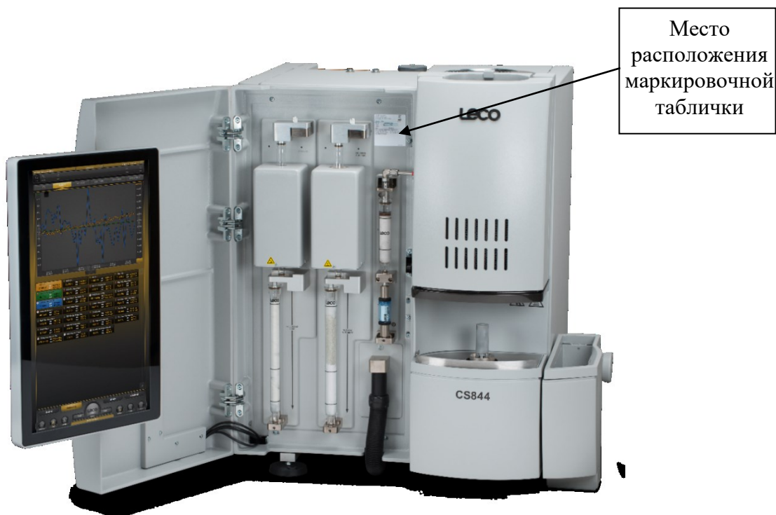
Рисунок 2 – Общий вид анализатора с открытой дверцей и местом расположения маркировочной таблички
