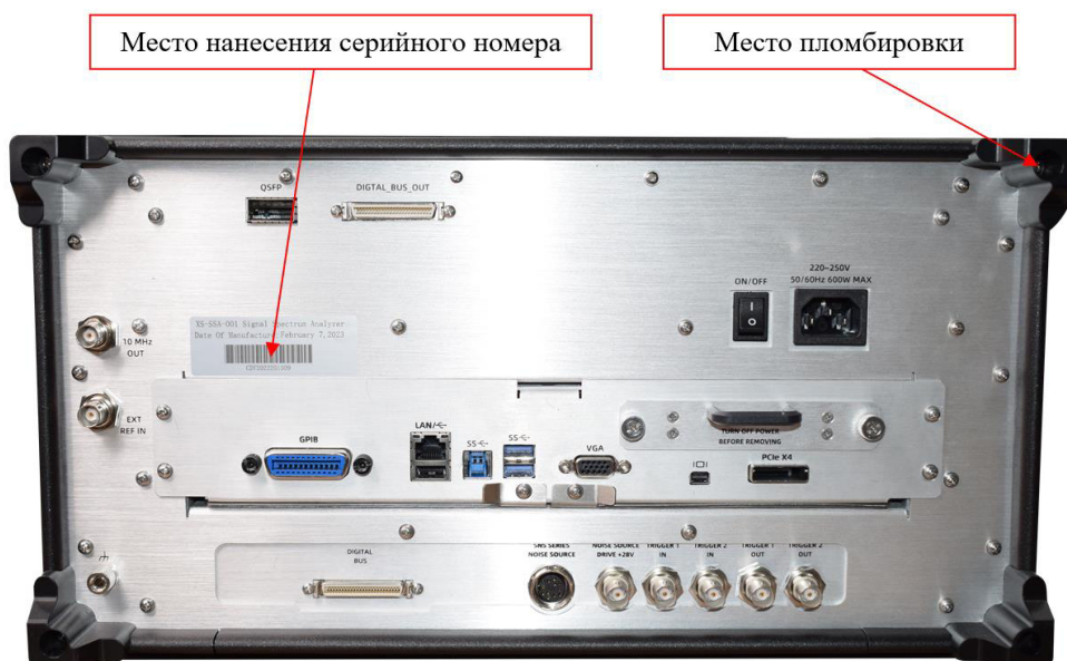
Рисунок 2 - Схема пломбировки от несанкционированного доступа и место нанесения серийного номера, идентифицирующего каждый экземпляр СИ
