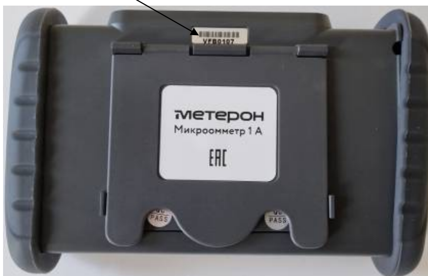
Рисунок 6 – Обозначение места нанесения заводских номеров на микроомметрах Метерон МИО-1, Метерон МИО-1Р, Метерон МИО-10
