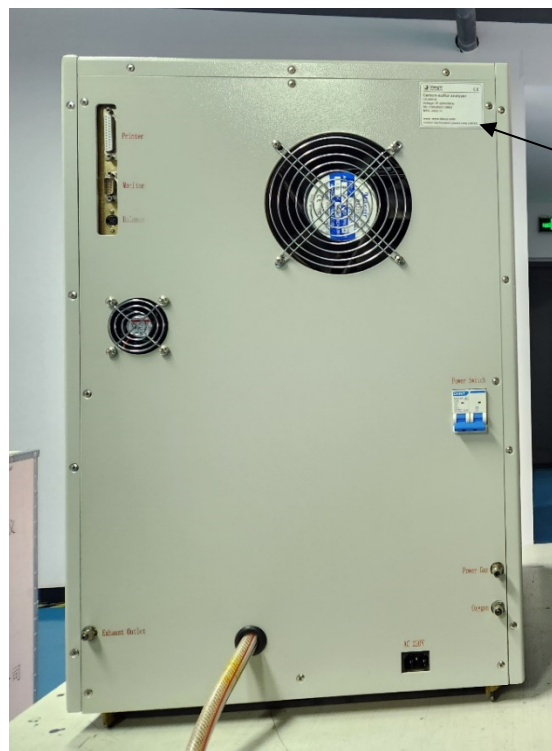
Рисунок 2 – Вид задней стенки анализатора с местом расположения маркировочной таблички
