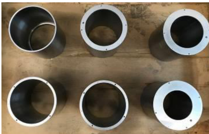
Рисунок 1 - Общий вид комплектов мер толщины стенки и внешнего диаметра 6048
