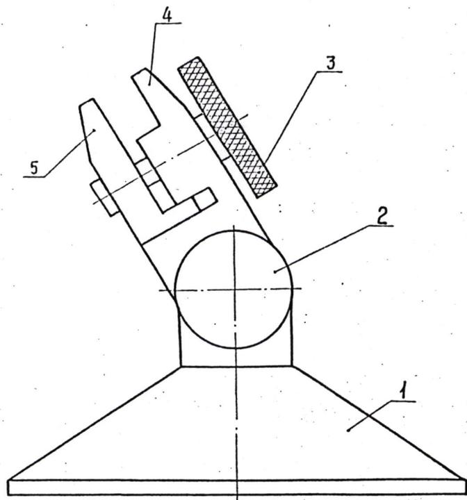
1 - основание, 2 - винт, 3 - гайка, 4 - неподвижная губка,
