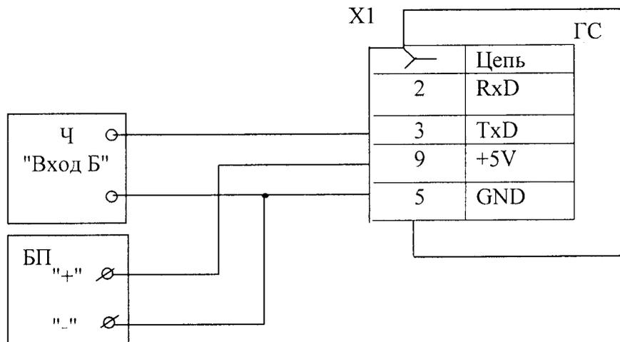
Ч – частотомер электронно-счетный ЧЗ-63;
