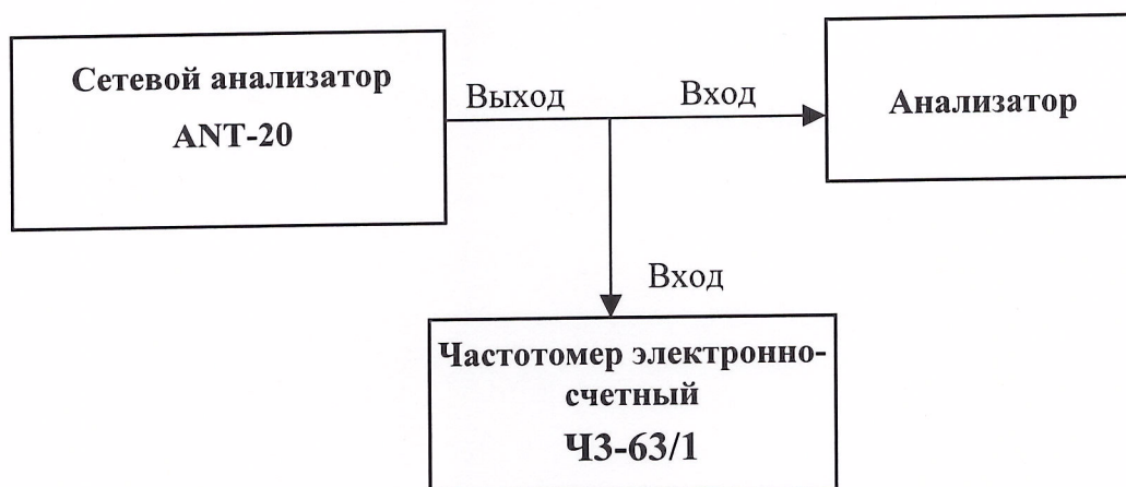
Рисунок 12. Измерение устойчивости анализатора к расстройке тактовой частоты входного сигнала.
