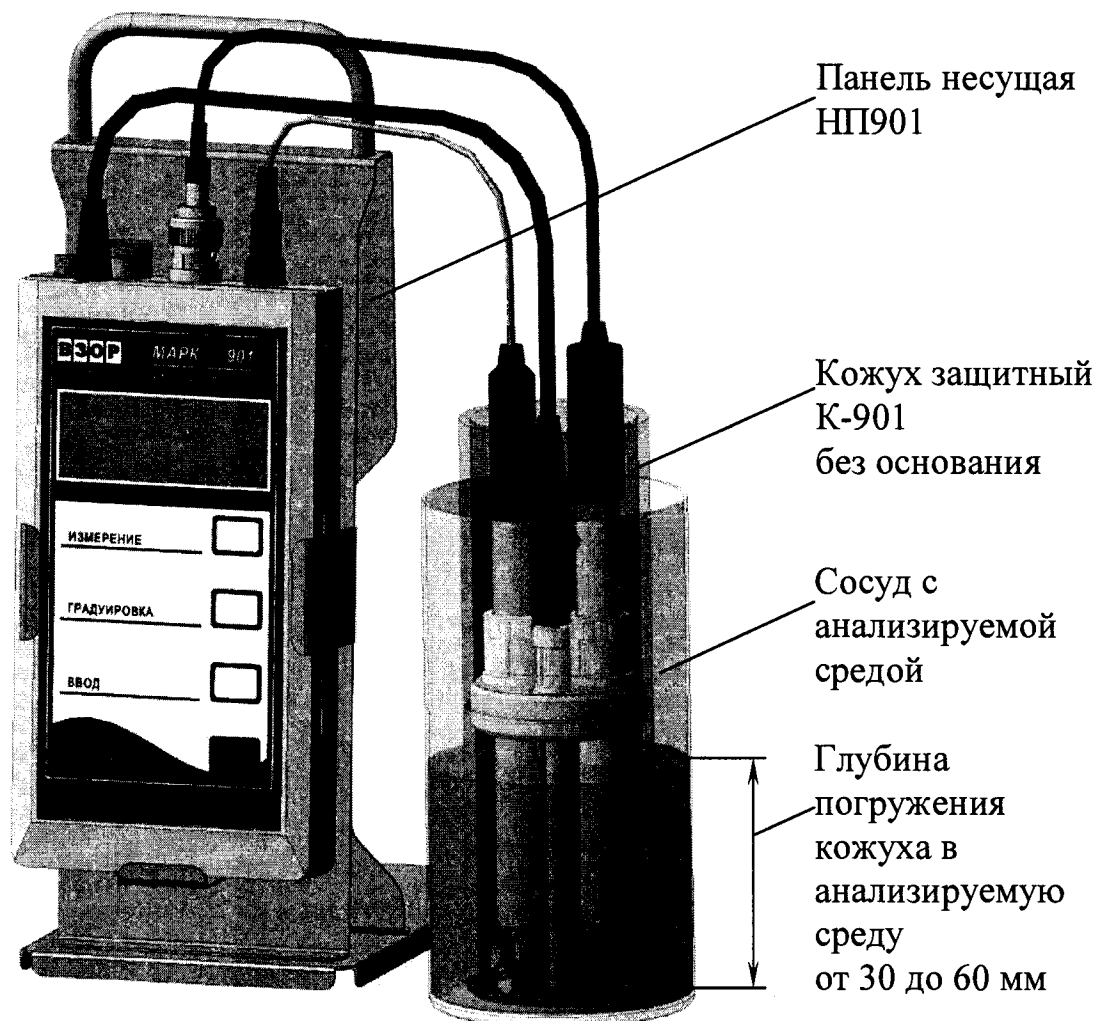
Рисунок 2.12 – Проведение измерений с использованием кожуха защитного К-901
