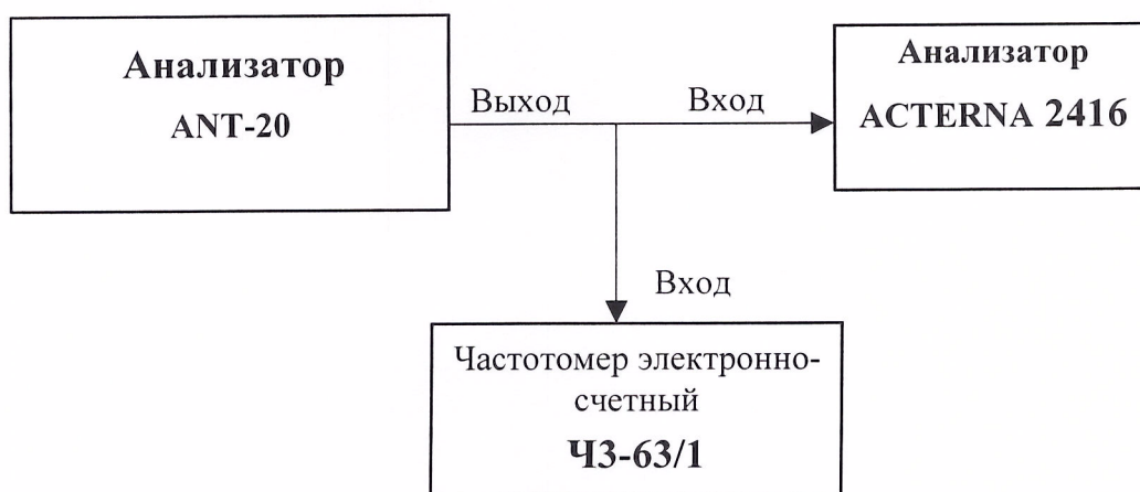
Рис.12. Измерение устойчивости анализатора АСТЕРНА 2416 к расстройке тактовой частоты входного сигнала.
