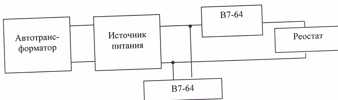
Рис. 2. Структурная схема соединения приборов при определении нестабильности выходного напряжения.
