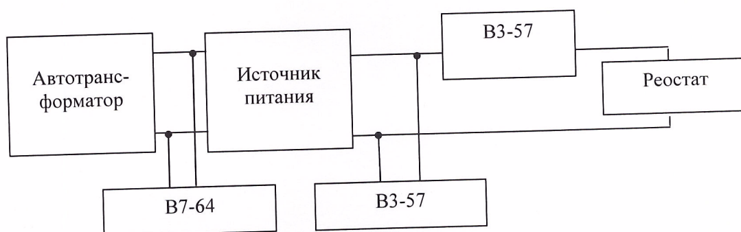
Рис. 3. Структурная схема соединения приборов при определении пульсации выходного напряжения.
