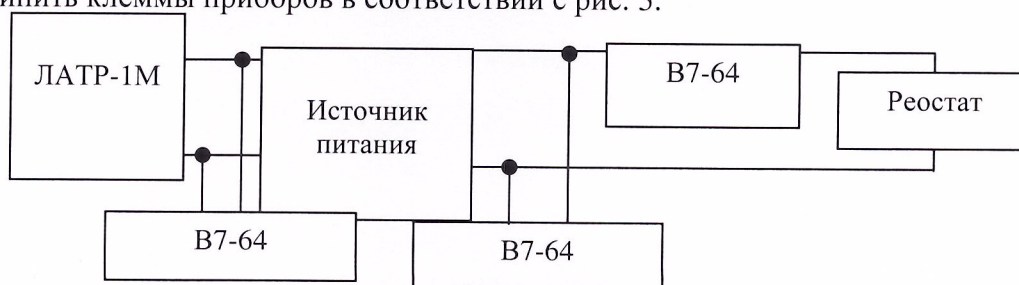
Рис. 3. Структурная схема соединения приборов при определении нестабильности выходного напряжения.
