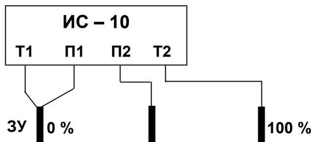
Рисунок 2.3.4 Схема измерения сопротивления заземления четырёхпроводным методом
