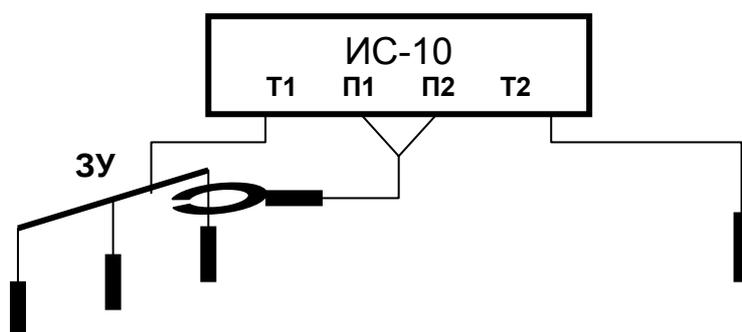
Рисунок 2.3.7.2 Определение процентного распределения токов через единичные заземлители
