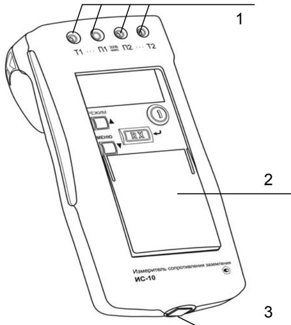
Рисунок 1.4 Общий вид прибора и расположение гнёзд подключения
