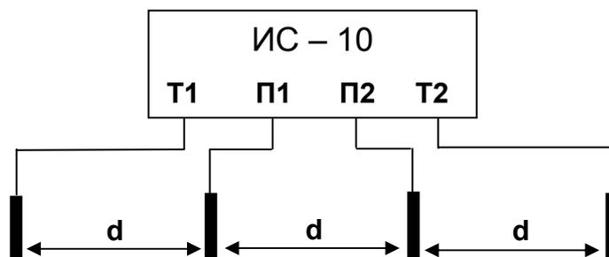
Рисунок 2.3.6 - Схема подключения при измерении удельного сопротивления грунта
