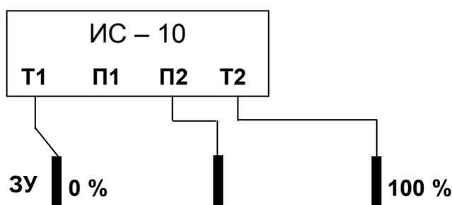
Рисунок 2.3.5 Схема измерения сопротивления заземления трёхпроводным методом
