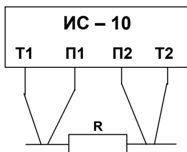
Рисунок 2.3.3.1 - Схема подключения при четырёхпроводном методе измерения
